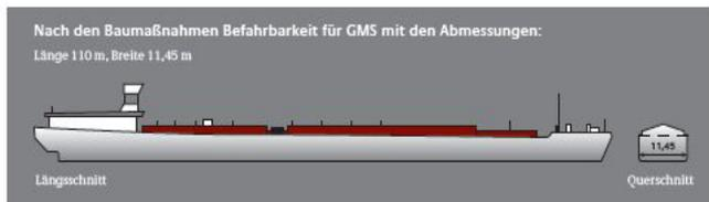
Tragfähigkeit ca. 2.100 t bei 2,80 m Tiefgang
