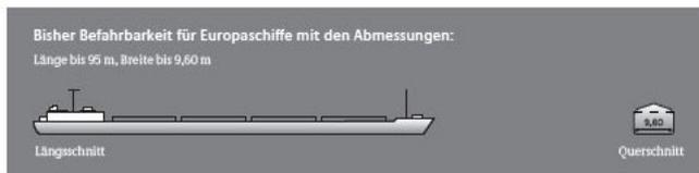
Tragfähigkeit ca. 1.350 t bei 2,50 m Tiefgang
